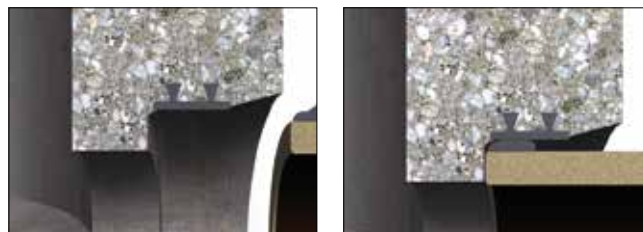
Esempio per la formazione del manicotto con innesto DS 55
