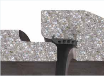
Drei Varianten der in Frankfurt erstmalig eingesetzten neuen DS-Dichtsysteme, die sowohl gegen alle auf dem Flughafen eingesetzten Enteisungsmittel als auch Kerosin absolut beständig sein mussten.
